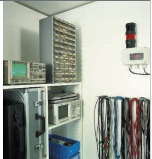
Die beiden Relaisausgänge des testo 54 ermöglichen dezentrale Alarme bei Grenzwertüberschreitung, z.B. mit Hilfe der Alarmsäule.
