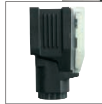
Der optionale Schaltausgangsstecker (0554 3302) ermöglicht neben dem 4 ... 20 mA-Ausgang zwei Schaltausgänge, deren Zustände durch zwei LED's angezeigt werden.
